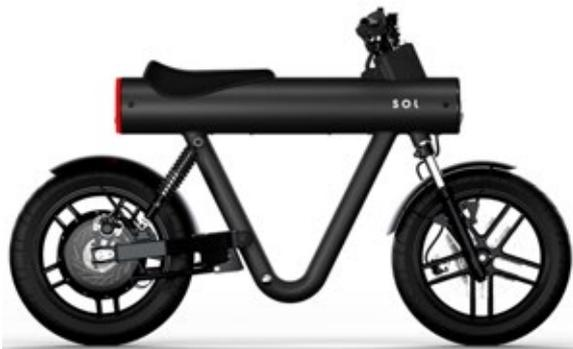
Abschluss des Projekts Wasserstoff-Leichtkraftrad Pocket Rocket H2 – ein Projekt für nachhaltige Mobilität: Die DHBW Mannheim hat herausgefunden, wie ein elektrisches Leichtkraftrad mit 150 km Reichweite und Betankung in unter einer Minute funktioniert. Mit dem Start-up SOL Motors GmbH aus Böblingen konnte das Leichtkraftrad Pocket Rocket durch einen Brennstoffzellenantrieb zu einer Pocket Rocket H2 upgradet werden.
